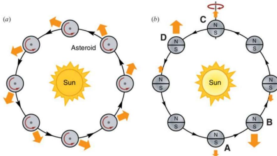
Схематичное представление суточного (а) и сезонного (б) эффекта Ярковского (Bottke et al., 2006, Annu. Rev. Earth Planet. Sci., 34). Причина ЭЯ: ненулевая тепловая инерция тела.
