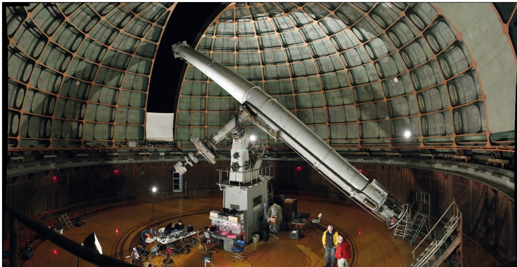
Рефрактор Ликской обсерватории Калифорнийского университета (1888 г.) D = 36 дюймов (91 см), установленный на горе Гамильтон в Калифорнии
