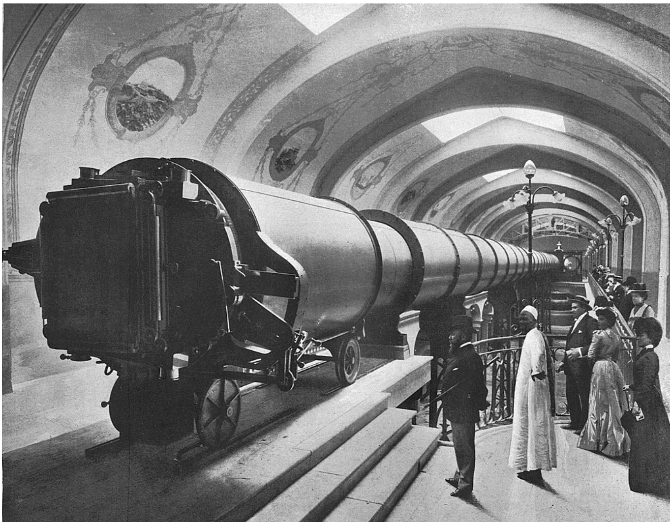
125-см горизонтальный рефрактор, изготовленный для Парижской выставки 1900 г.
