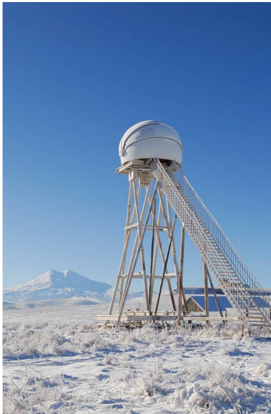
МАСТЕР (М обильная А строномическая С истема Т елескопов- Р оботов), D = 40 см, F = 1 м, поле 4 кв. гр. Благовещенск, Иркутск, Екатеринбург, Кисловодск, ЮАР, Канарские острова и Аргентина
