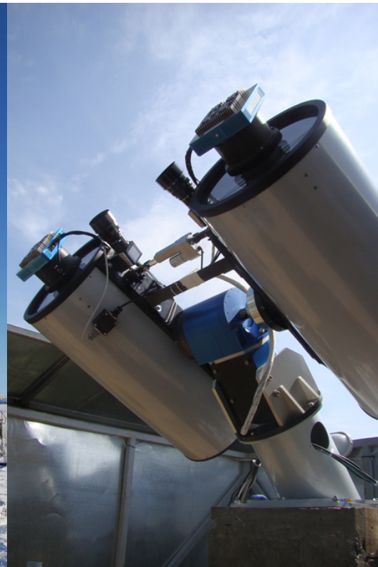
МАСТЕР (М обильная А строномическая С истема Т елескопов- Р оботов), D = 40 см, F = 1 м, поле 4 кв. гр. Благовещенск, Иркутск, Екатеринбург, Кисловодск, ЮАР, Канарские острова и Аргентина
