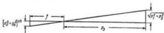
Рис. 11. Геометрия оптической системы камеры.
