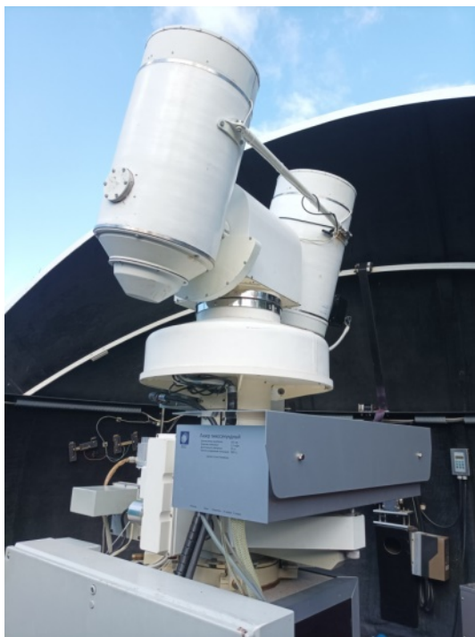
Рис. 3. Расположение частей лазера в башне: a) лазерный излучатель и b) термошкаф
