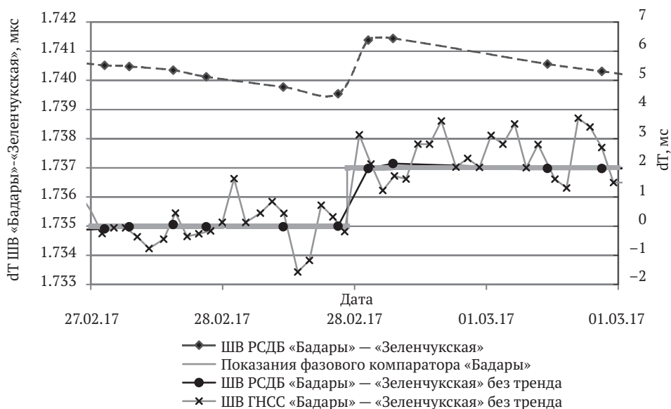
Рис.1. Результаты сравнения шкал времени при сдвиге фазы опорного сигнала в одной обсерватории
