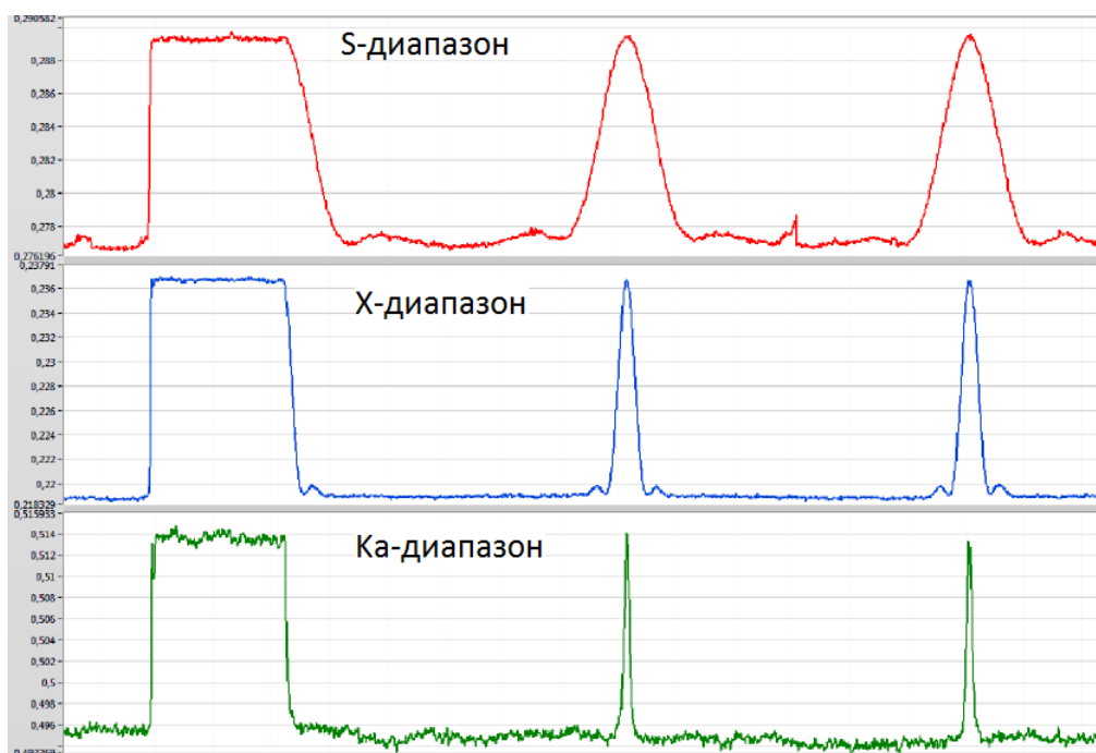
Рисунок 5.2 — Наблюдения источника «Taurus-A» в обсерватории «Бадары» одновременно в S/X/Ka-диапазонах
