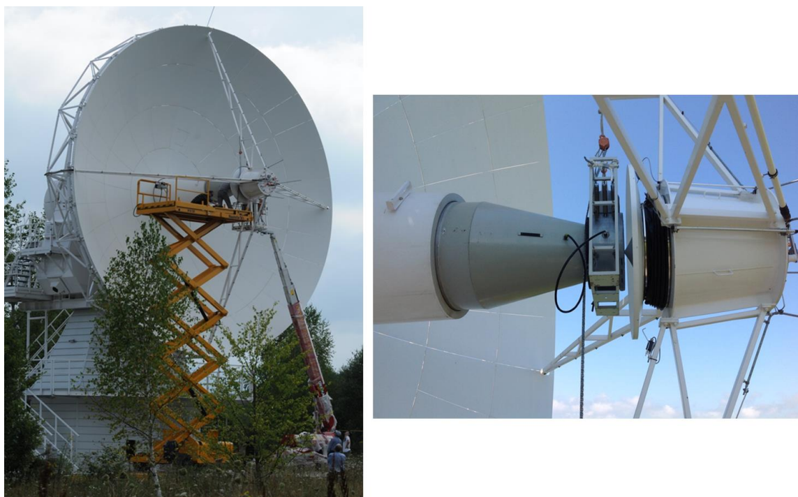
Рисунок 5.1 — Измерения шумовой температуры радиотелескопа РТ-13 с помощью широкоапертурного низкотемпературного генератора шума [A3]
