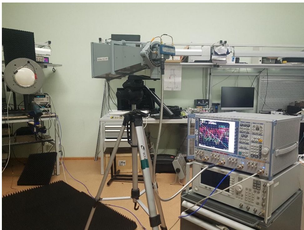
Рисунок 2.16 — Фотография стенда для измерения групповой задержки криогенного приемного фокального блока
