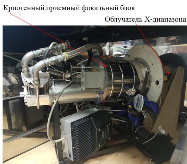
Рисунок 4.12 — Криогенный приемный фокальный блок в термокамере
