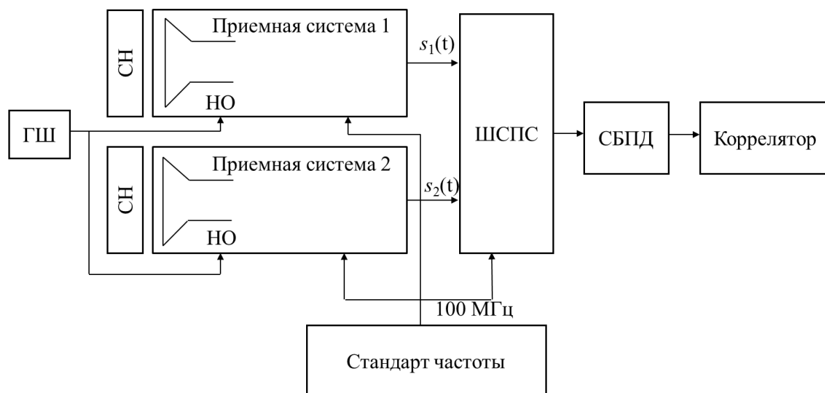
Рисунок 2.18 — Структурная схема макета радиоинтерферометра: ШСПС — широкополосная цифровая система преобразования сигналов, ГШ — генератор шума, НО — направленный ответвитель, СН — согласованная нагрузка, СБПД — система буферизации и передачи данных [А4]
