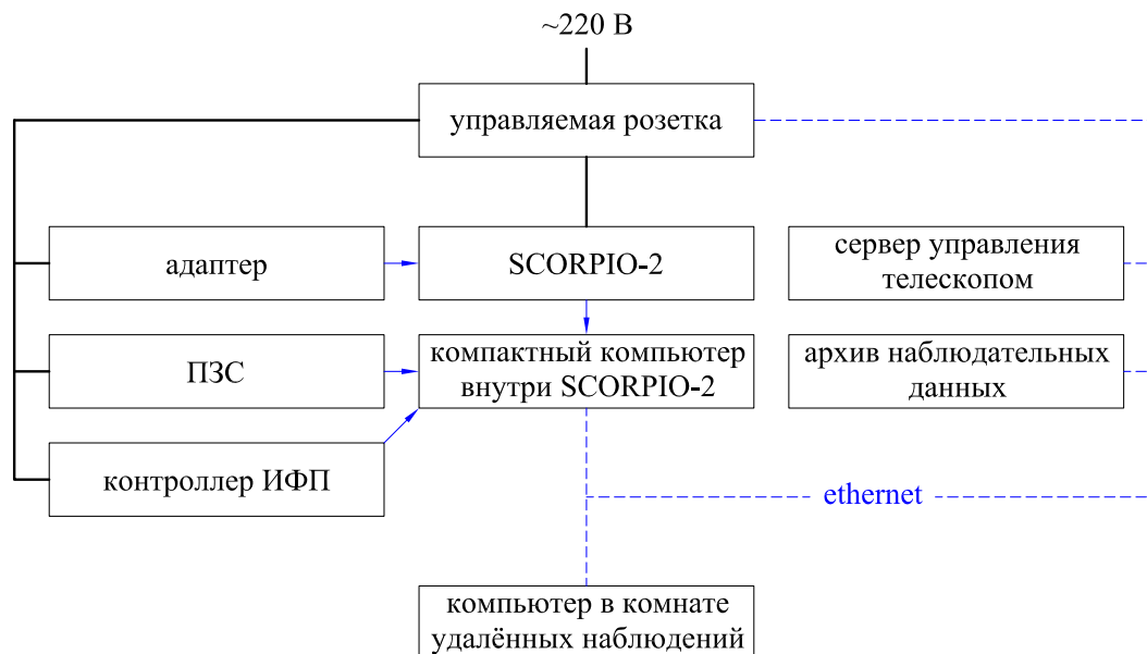
Рис. 10. Блок-схема организации удалённых наблюдений со SCORPIO-2 [33]
