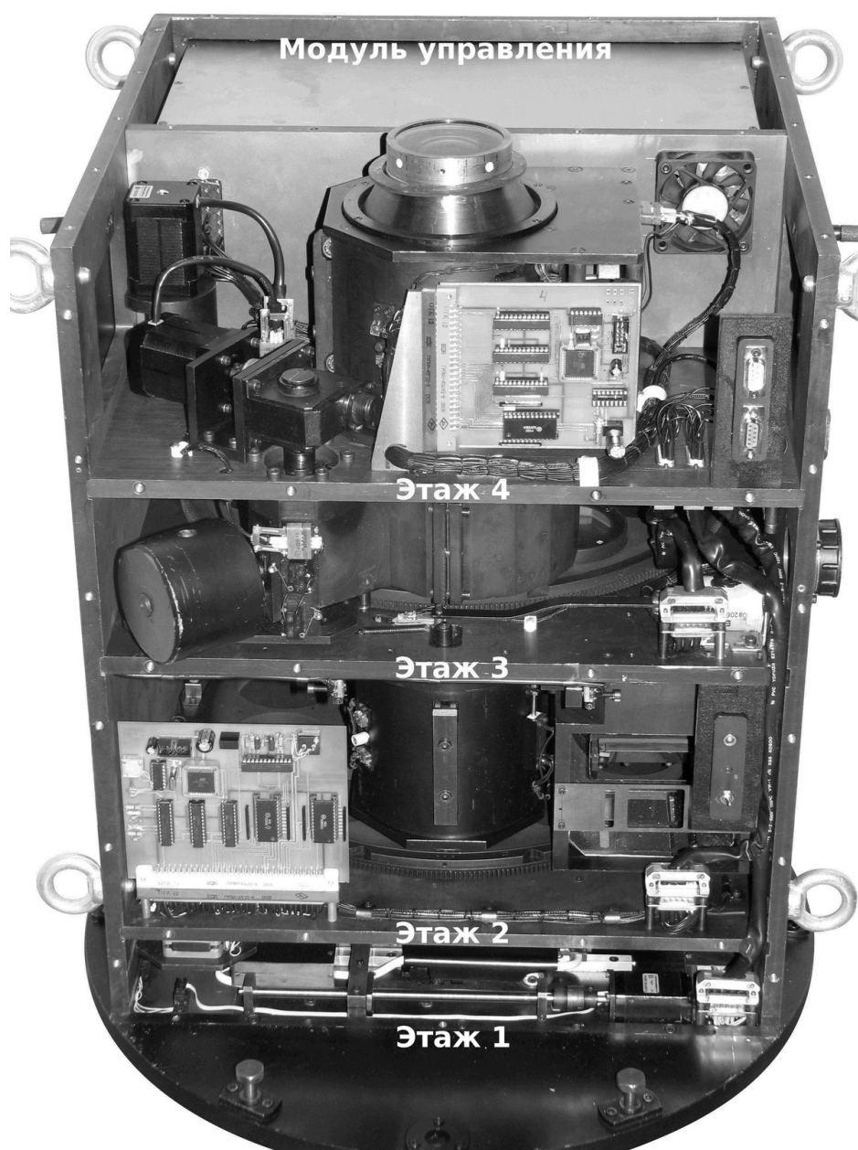
Рис. 4. Модульная конструкция SCORPIO-2: 1-й этаж смонтирован на фланце и снимается вместе с ним; этажи 2-4 извлекаются из направляющих пазов при демонтированном блоке IFU и снятой верхней крышке. На фотографии видны платы управления 2-м и 4-м этажами, а в правой части — разъёмы подключения общей линии питания и связи к этажам 1-3 [33]
