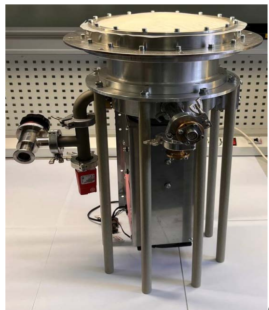
Рис. 1. а) ШКПФБ(С) без защитного металлического кожуха; б) ШКПФБ(С), в защитном кожухе с радиопрозрачным вакуумным окном
