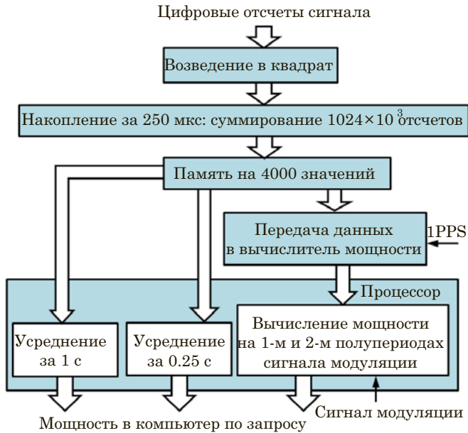
Рис. 7. Алгоритм цифровой обработки сигналов в режиме радиометрической регистрации
