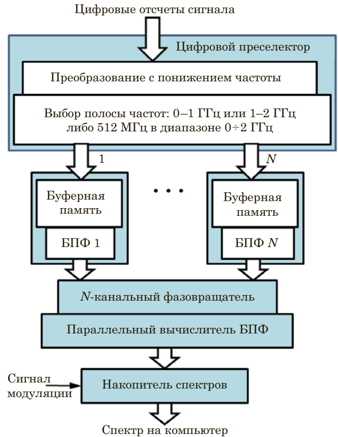
Рис. 8. Алгоритм цифровой обработки сигналов при их регистрации в режиме спектрально-селективного радиометра
