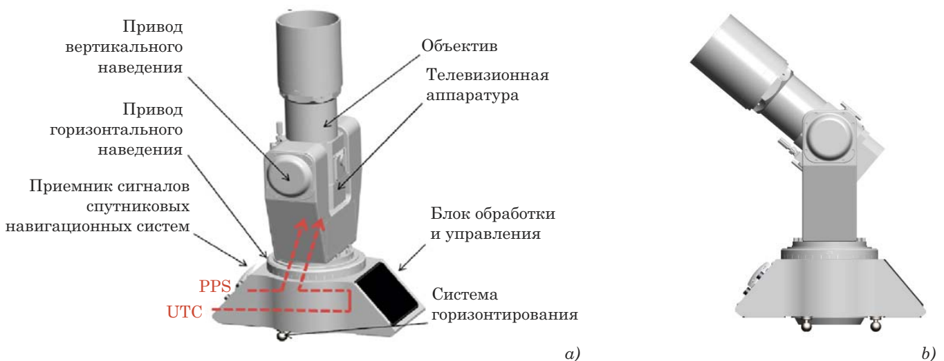
Рис. 1. Автоматизированный астрономический универсал а) при определении астрономических координат; б) при определении азимута визирной оси
