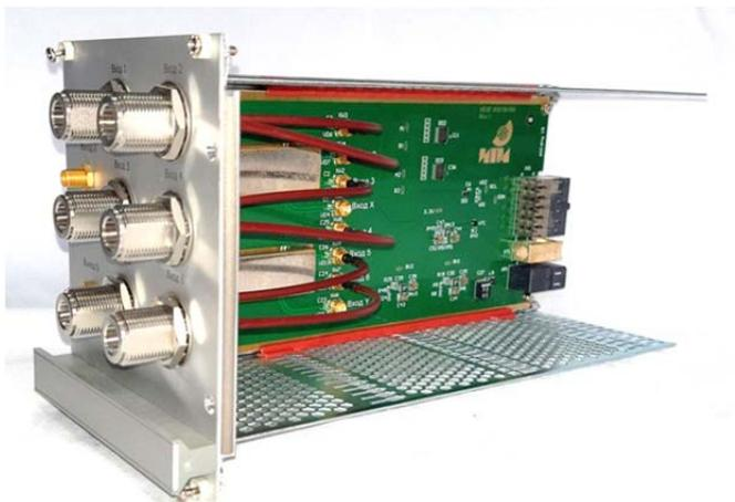
Рис. 2. Кассета распределителя сигналов ПЧ со снятой боковой стенкой
