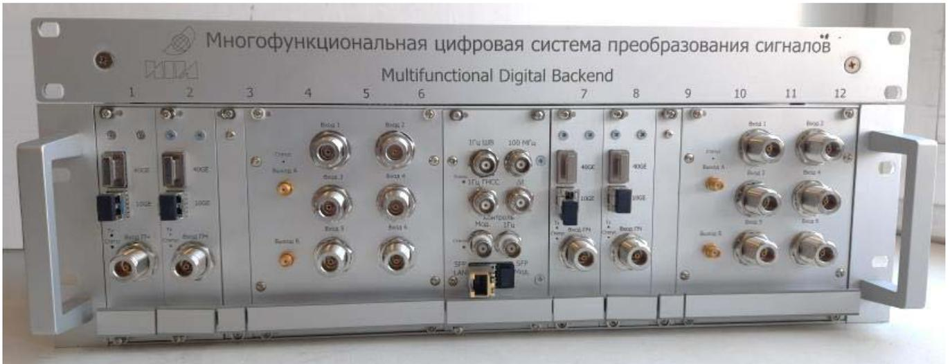
Рис. 3. Опытный образец МСПС для радиотелескопа РТ-32
