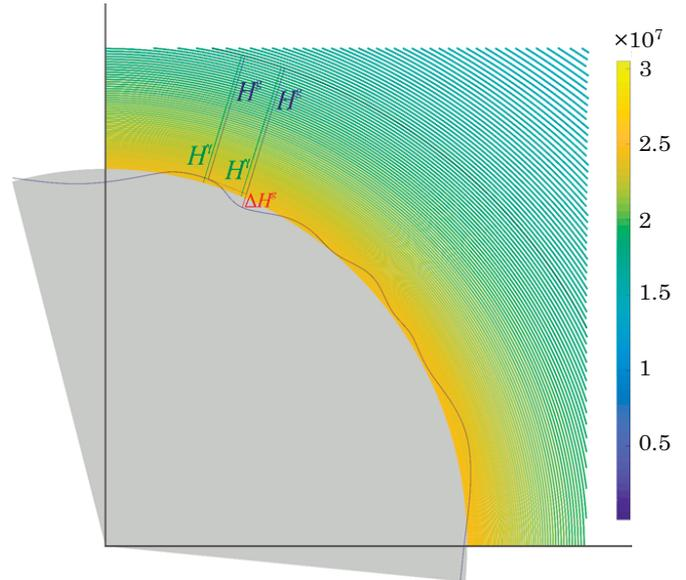
Рис. 2. Поведение ортометрической высоты на большом удалении от Земли (серая заливка); на цветной шкале показано сечение уровней поверхностей потенциала силы тяжести, проведенных с шагом  $100\,000\text{ м}^2/\text{с}^2$
