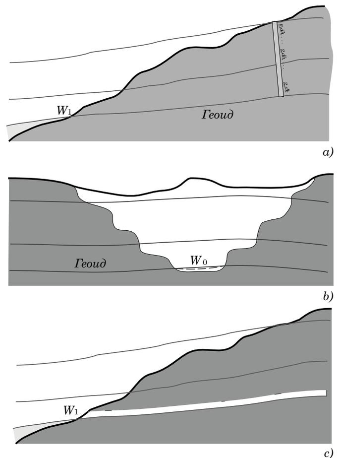
Рис. 1. Практические способы отыскания геоида: а) с использованием скважинного гравиметра в вертикальной шахте; б) геометрическое нивелирование в глубь карьера; в) строго горизонтальная шахта от берега или футштока
