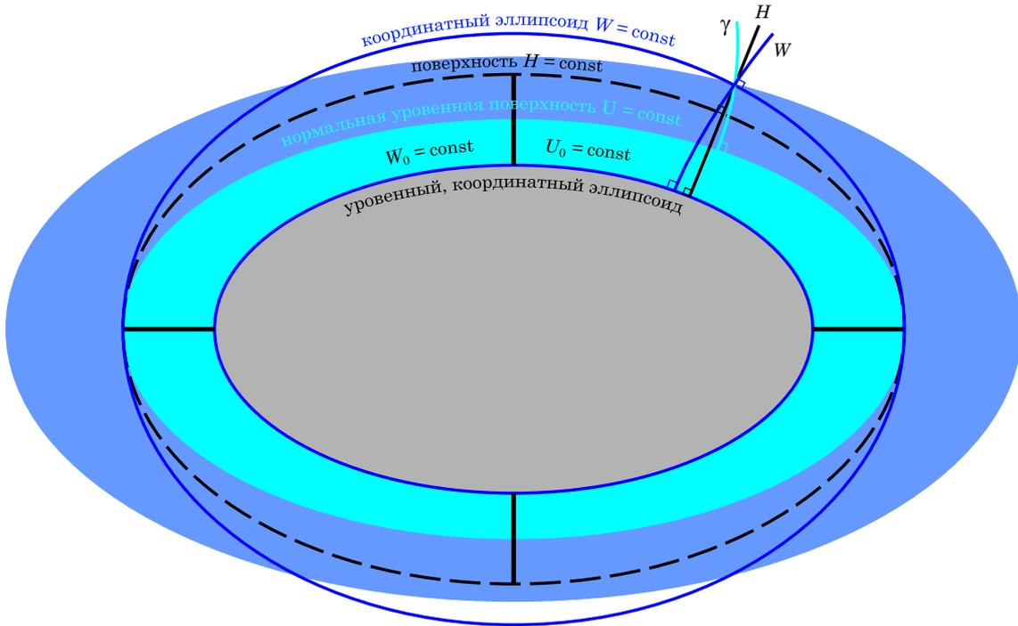
Рис. 3. Направления, используемые в нормальной системе высот:  $H$  — нормаль к уровенному эллипсоиду,  $\gamma$  — силовая линия нормального поля,  $w$  — координатная линия сфероидальной системы координат
