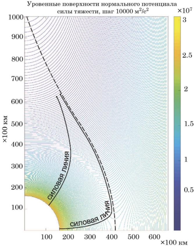
Рис. 4. Недостаток определения нормальной высоты как длины силовой линии. Пунктиром показана силовая линия, проходящая через точку разрыва непрерывности потенциала силы тяжести
