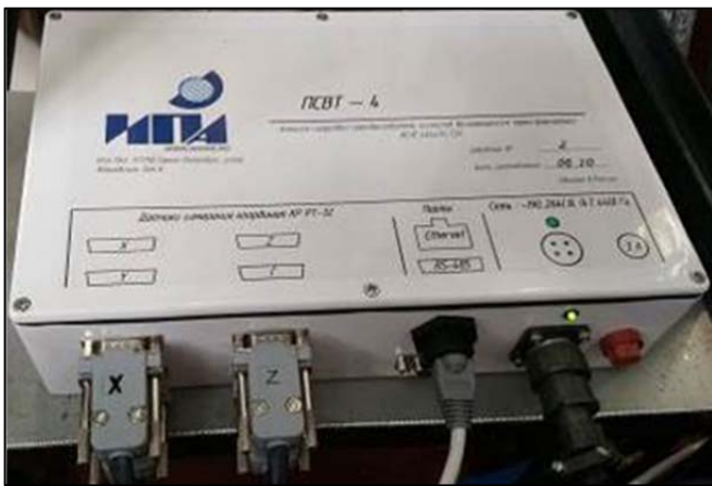
Рис. 4. Блок ПСВТ-4 из состава УПК-КР УСУК антенной системы радиотелескопа РТ-32
