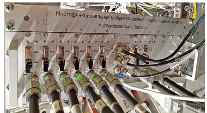
Рис. 4. Опытный образец МСПС в обсерватории «Светлое»
