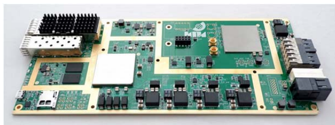
Рис. 2. Модуль ЦПС без радиатора
