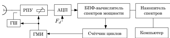
Рис. 1. Структурная схема спектрально-селективного радиометра
