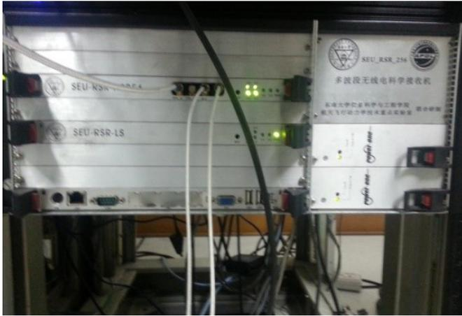
Рис. 2. Приемник для радиолокационных и доплеровских измерений
