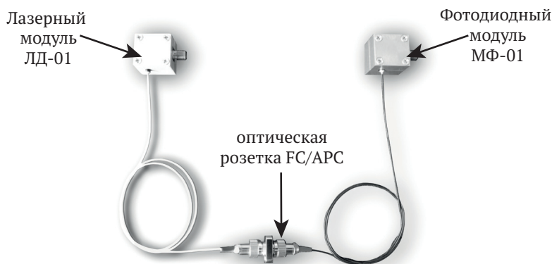
Рис. 4. Фото волоконно-оптической линии ВОЛП-01
