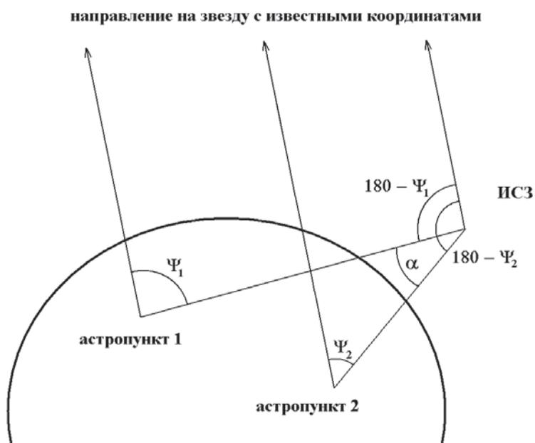
Рис. 2. Измерение положения искусственного спутника Земли (ИСЗ) относительно звезды из наземного пункта эквивалентно измерению положения пункта относительно звезды с борта ИСЗ
