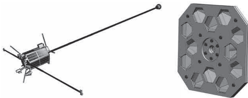
Рис. 1. Внешний вид МКА «М. Решетнев» и внешний вид платформы с уголковыми отражателями, установленной на нем
