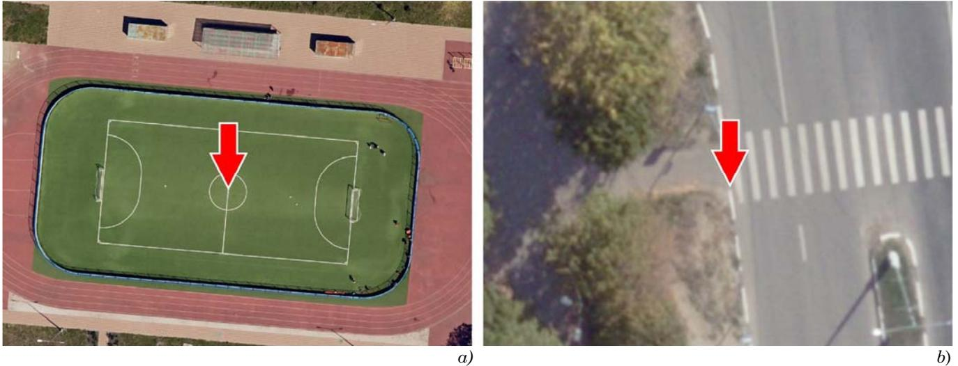
Рис. 3. Контрольные точки полигона в виде: а) элементов разметки спортивных площадок, б) элементов дорожной разметки
