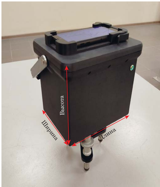
Рис. 2. Малогабаритный носимый высокоточный относительный гравиметр «Пешеход»
