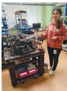
Рис. 1. Микроволновые и оптические СЧВ ФГУП «ВНИИФТРИ»
