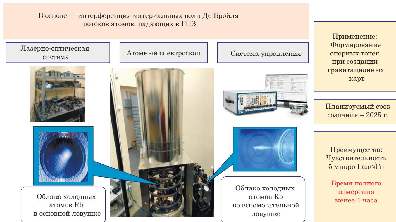
Рис. 3. Абсолютный квантовый атомный гравиметр «фонтанного» типа ФГУП «ВНИИФТРИ»
