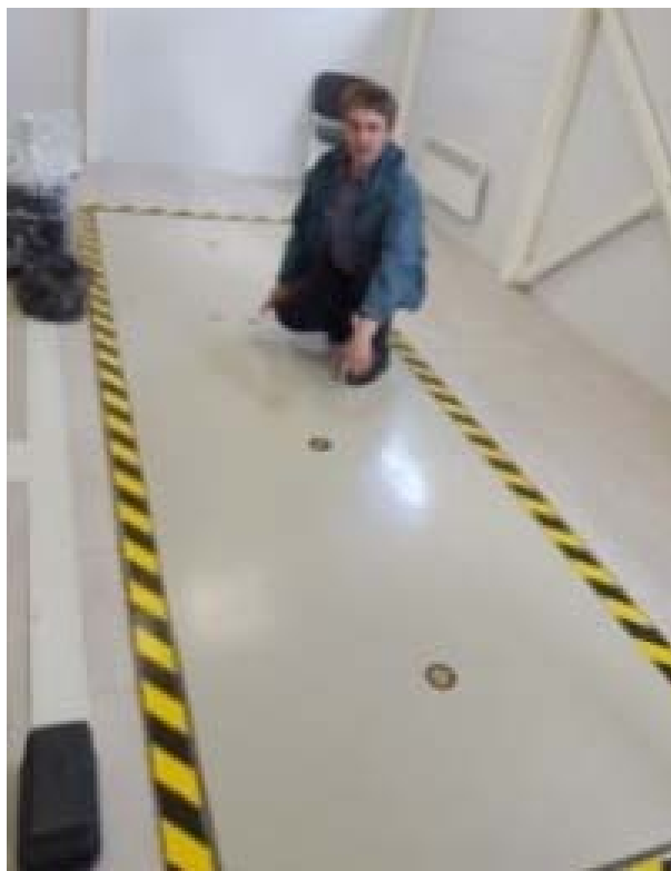
Рис. 13. Стенд для проведения гравиметрических измерений с отмеченными маркерами станций
