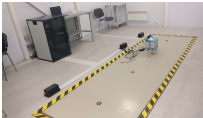
Рис. 17. Измерение УСП на станции 2 нового ГП с помощью относительного гравиметра Scintrex CG-6 Autograv
