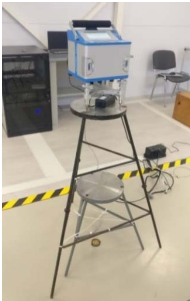
Рис. 18. Измерение для определения вертикального градиента УСП на станции 3 нового ГП
