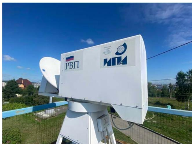
Рис. 1. Радиометр водяного пара на полигоне ВСФ ФГУП «ВНИИФТРИ»
