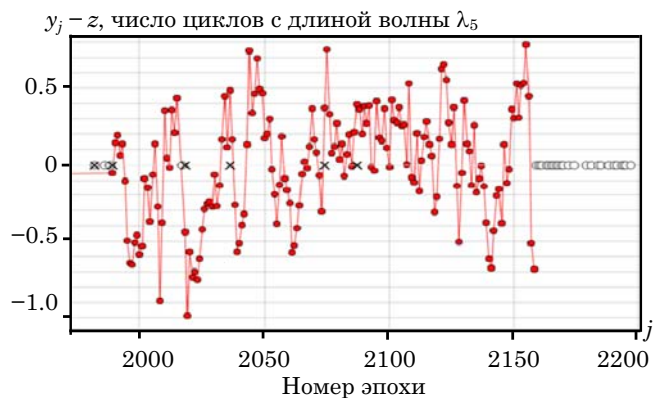
Рис. 12. Отклонения значений комбинации Мельбурна – Вуббена от среднего значения после детектирования и исключения скачков методом (Bezmenov, 2021); крестами обозначены эпохи обнаруженных скачков
