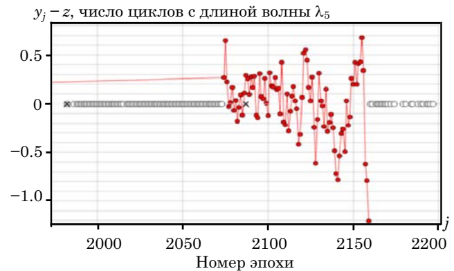
Рис. 11. Отклонения значений комбинации Мельбурна – Вуббена от среднего значения после детектирования и исключения скачков методом из Bernese GNSS Software, 2015; крестами обозначены эпохи обнаруженных скачков
