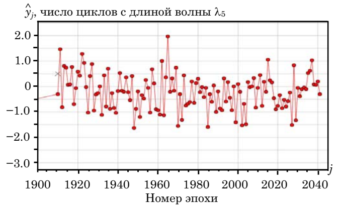
Рис. 1. Значения линейной комбинации Мельбурна – Вуббена, сформированной из данных измерений станции TLSE, полученных по результатам приема сигналов от спутника ГЛОНАСС с PRN = 1, год 2010, номер дня года 207
