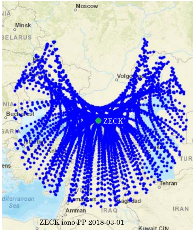
Рис. 3. Точки прокола ионосферы для одной станции на суточном интервале
