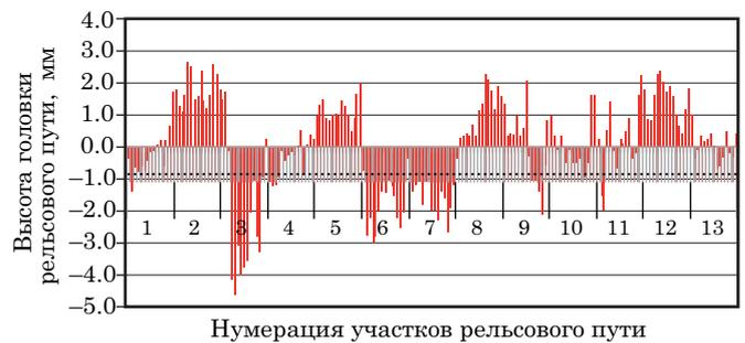
Рис. 5. Уровень головки рельсового пути РТ-32 обсерватории «Зеленчукская» по результатам измерений в марте 2020 г.
