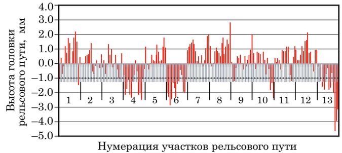
Рис. 4. Уровень головки рельсового пути РТ-32 обсерватории «Светлое» по результатам измерений в мае 2020 г.
