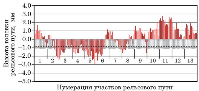
Рис. 6. Уровень головки рельсового пути РТ-32 обсерватории «Бадарь» по результатам измерений в сентябре 2019 г.
