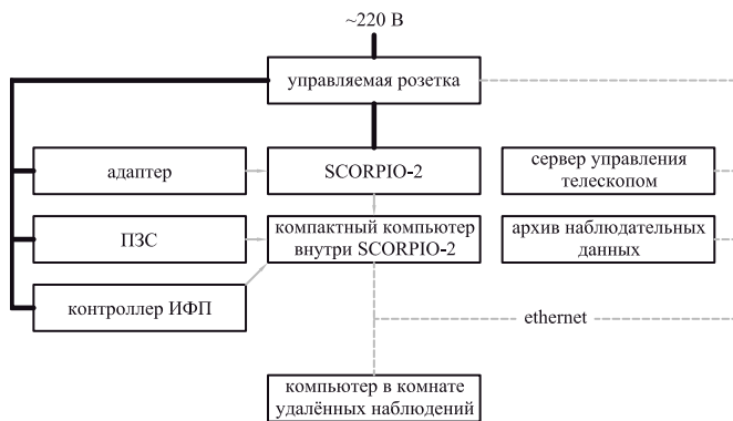
Рис. 7. Блок-схема организации удалённых наблюдений со SCORPIO-2
