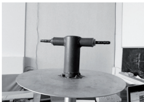
Рис. 1. Дипольная антенна на частотный диапазон 600 МГц
