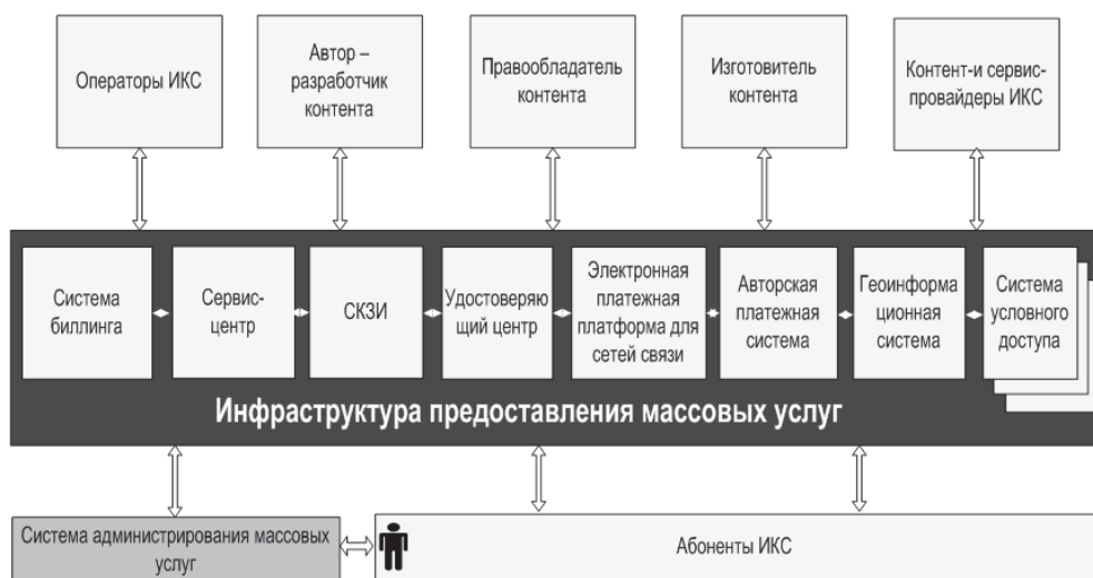
Рис. 1. Система администрирования услуг (ИКС – информационная коммуникационная система; СКЗИ – система криптозащиты информации)
