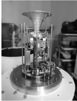
Рис. 2. Фотография ШКПФБ, без корпуса и азотного экрана
