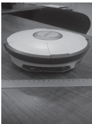
Рис. 1. Доработанный серийный геодезический приёмник «Торсон»
