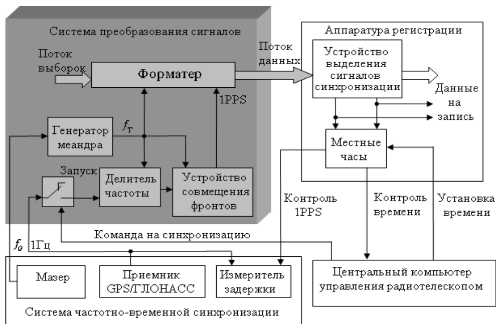
Рисунок 3 – Функциональная схема синхронизации данных при их регистрации на радиотелескопе
