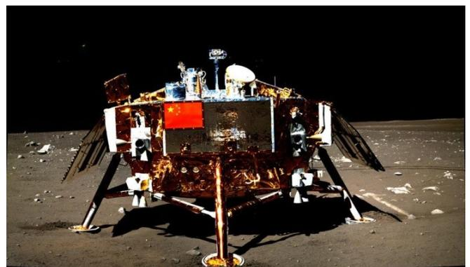
Рис. 4. Посадочный аппарат СЕ-3: параболическая антенна с большим усилением, которая работает в диапазоне X в экспериментах по радиолокации
